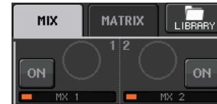
Aparece un círculo gris en lugar del mando TO MIX SEND LEVEL y no se puede ajustar el nivel de envío.
