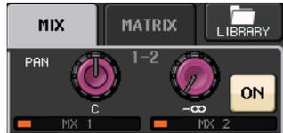
Puede enlazar los parámetros principales de dos buses MIX/MATRIX par e impar adyacentes. Si el bus MIX/MATRIX de destino de envío se asigna como estéreo, el mando izquierdo de los dos mandos TO MIX/MATRIX SEND LEVEL adyacentes funcionará como mando TO MIX/MATRIX PAN. (Si el modo BALANCE está seleccionado en la ventana TO STEREO/MONO, funcionará como mando BALANCE.)
